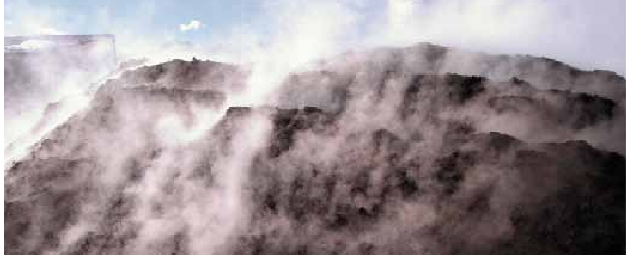
切返し作業を行い、発酵分解を促進させて製品化する
